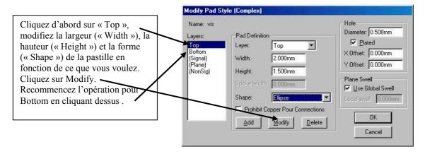
Une fois ces opérations effectués, cliquez sur OK et vous reviendrez sur la fenêtre « Option Pad Style ». Cliquez sur « Close » et vous reviendrez automatiquement sur la fenêtre « Pad Properties ». En face de « Pad Style » sélectionnez votre pastille nouvellement créée et cliquez sur « OK ».
